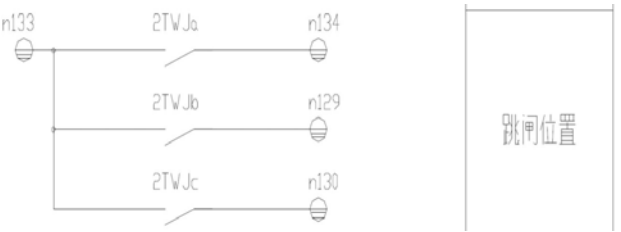
图 2 CZX-12R 操作箱与第一套保护及重合闸配合回路
